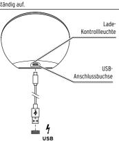
1. Schließen Sie das eine Ende des USB-Anschlusskabels an die USB-Anschlussbuchse am Gerät und das andere Ende an einen geeigneten USB-Netz-
