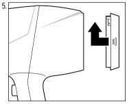
Setzen Sie das Luftgitter wieder auf und drehen Sie es im Uhrzeigersinn, bis es spürbar einrastet
