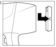
Drehen Sie das Luftgitter gegen den Uhrzeigersinn und nehmen Sie es ab.
